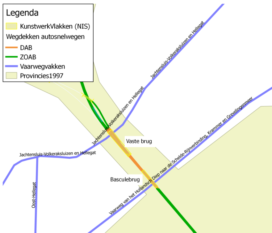
Figuur 4 Wegvak tussen de basculebrug en de vaste brug bij de Volkeraksluizen heeft een DAB-deklaag, waardoor de dichte deklagen op de twee bruggen met elkaar verbonden zijn.
