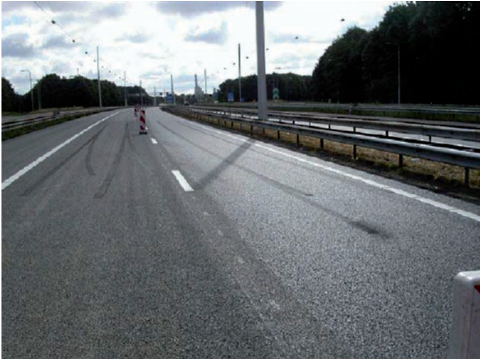
Remproeven op wel (links) en niet (rechts) afgestrooid ZOAB.
