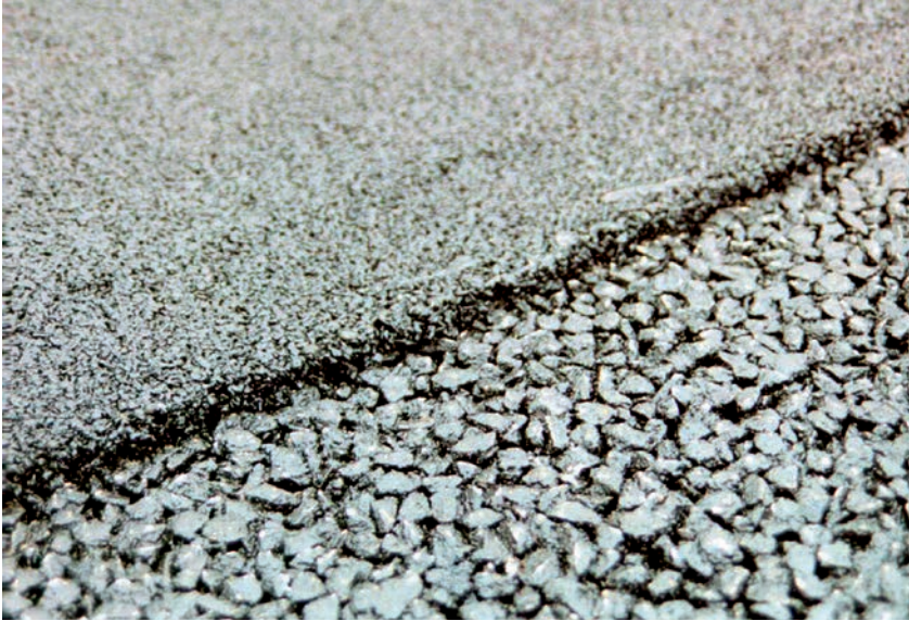
Tweelaags ZOAB bestaat uit een toplaag fijn ZOAB gelegen op een onderlaag grof ZOAB.
